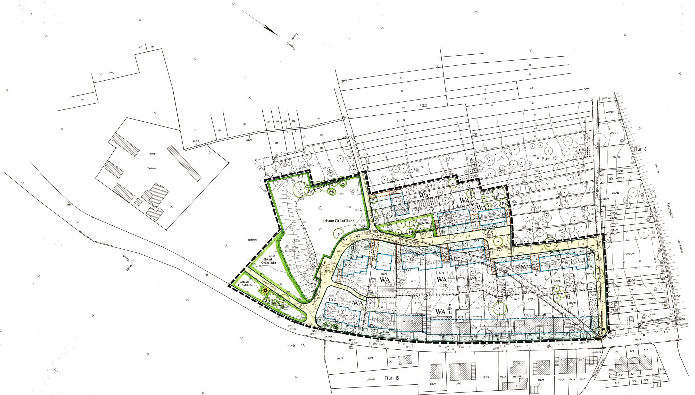
Hinweis: Die mit (D) gekennzeichneten Grundstücke können nur durch eine Hebeanlage entwässert werden.
