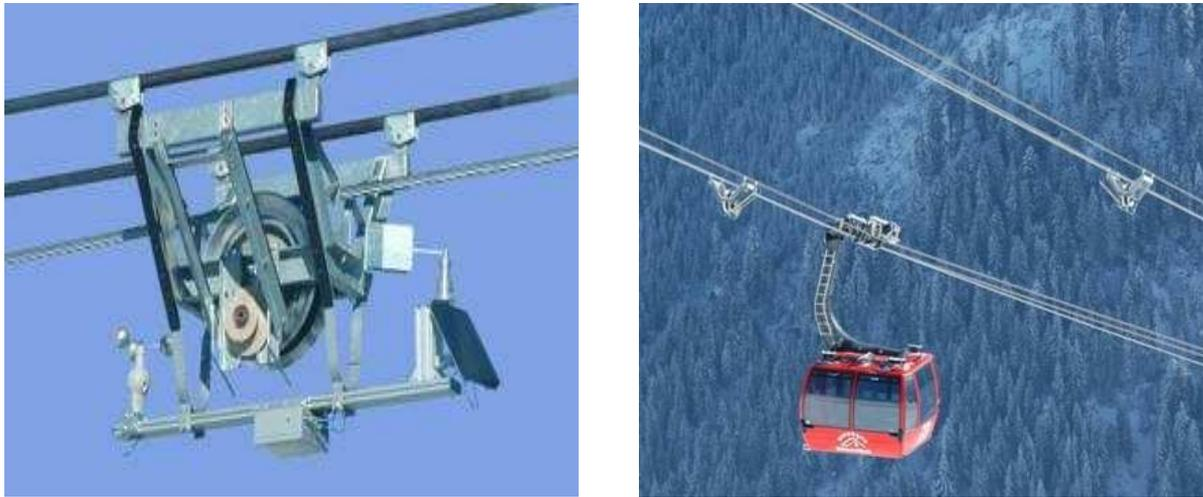
**Abb. 15: Fotos: Seilreiter im Detail und Größenvergleich Seilreiter und Kabine (Quelle: Fa. Doppelmayr)**
